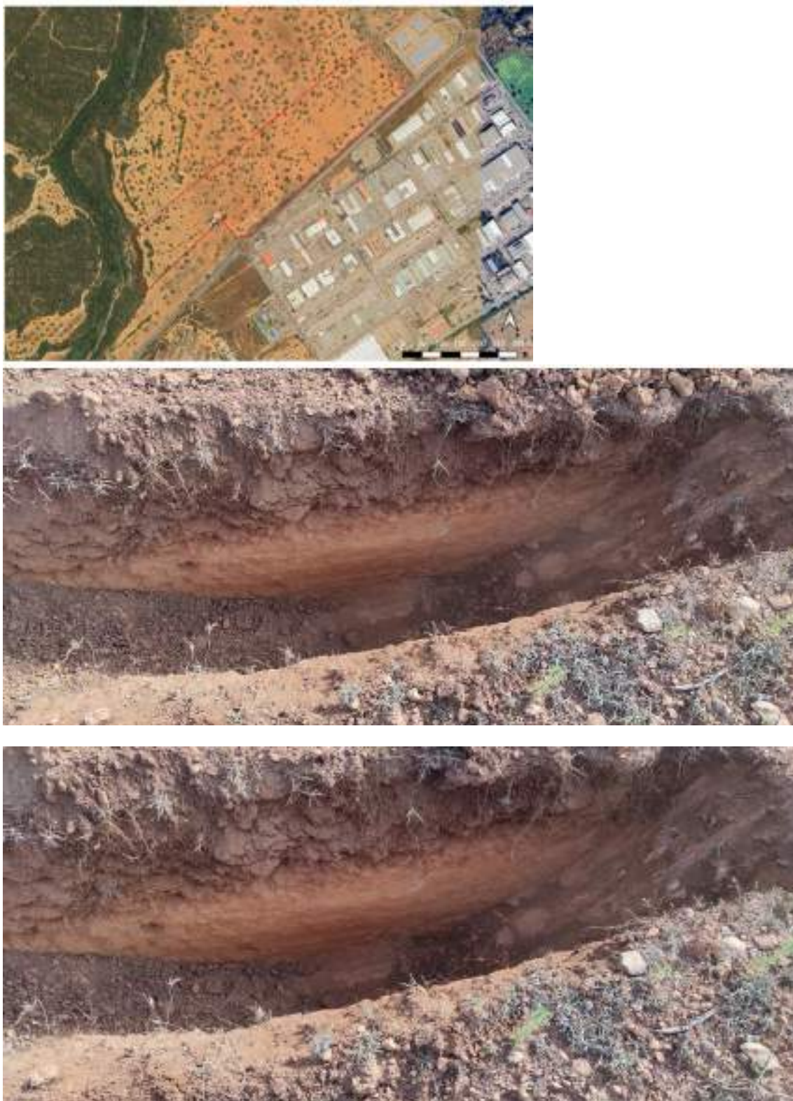
Figura 15. Sondeo #6. Paquete de tierra vegetal de ~38 cm de potencia sobre substrato geológico de arcillas ilíticas.
