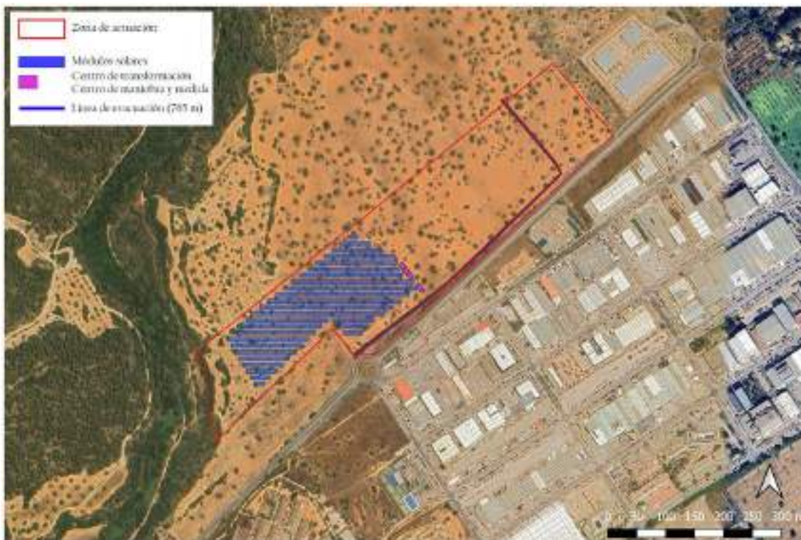
Figura 2. Instalaciones previstas en el parque solar fotovoltaico Son Pillo (Santa Ponça, Calvià).
