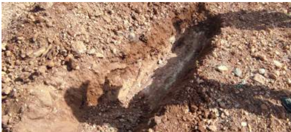
Figura 10. Sondeo #1. Paquete de tierra vegetal de ~35 cm de potencia sobre sustrato geológico de calcoarenita.
