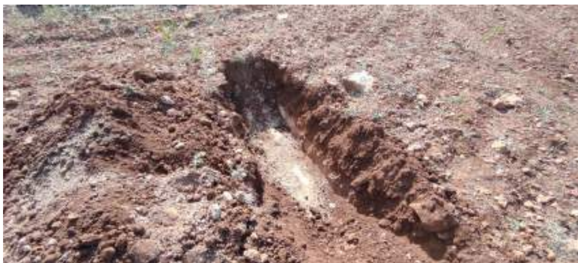
Figura 12. Sondeo #3. Paquete de tierra vegetal de ~35 cm de potencia sobre substrato geológico de calcoarenita.
