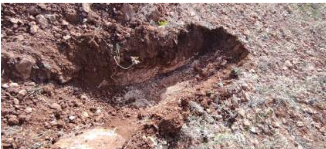
Figura 14. Sondeo #5. Paquete de tierra vegetal de ~42 cm de potencia sobre substrato geológico de calcoarenita.
