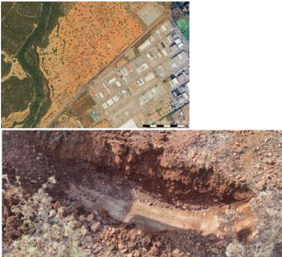
Figura 9. Sondeo #1. Paquete de tierra vegetal de ~35 cm de potencia sobre substrato geológico de calcoarenita.
