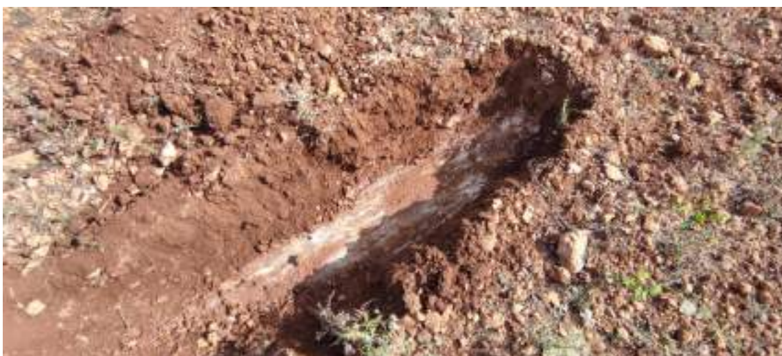
Figura 13. Sondeo #4. Paquete de tierra vegetal de ~46 cm de potencia sobre substrato geológico de calcoarenita.
