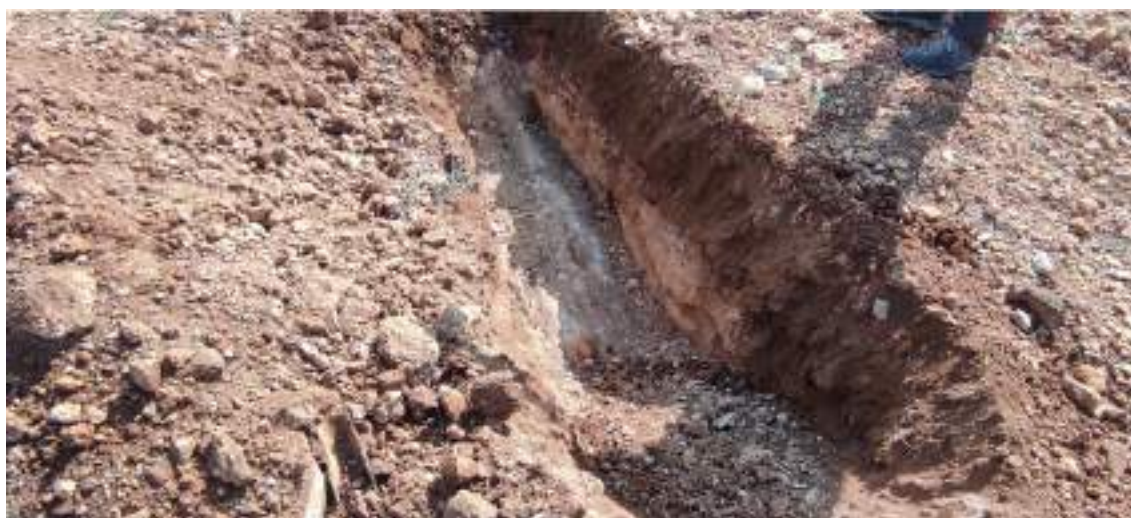
Figura 11. Sondeo #2. Paquete de tierra vegetal de ~33 cm de potencia sobre substrato geológico de calcoarenita.
